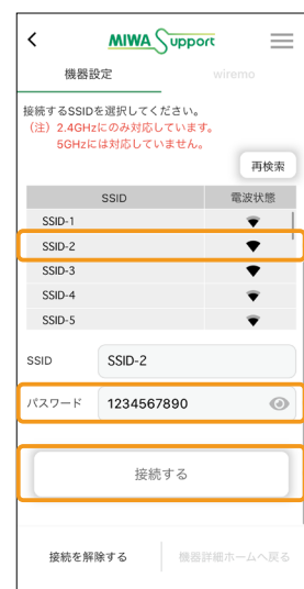
6 接続する無線ルーターの【SSID】をタップし、【パスワード】を入力して【接続する】をタップします。
